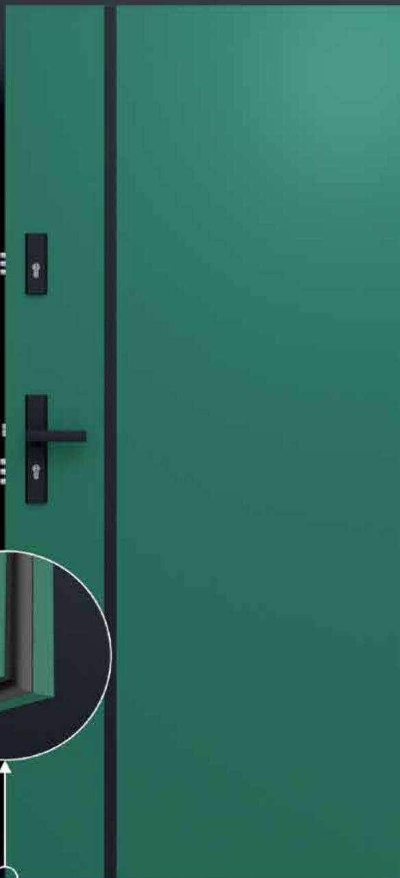
Die Grundlage der **72 Ecotherm** Tür ist ein 72 mm dicker Flügel mit dem Falz an vier Seiten und Glaspaket mit Scheibenzwischenraum mit Füllung aus PUR-Schaum, erzeugt aus laminierten bzw. lackierten Zinkblech.
